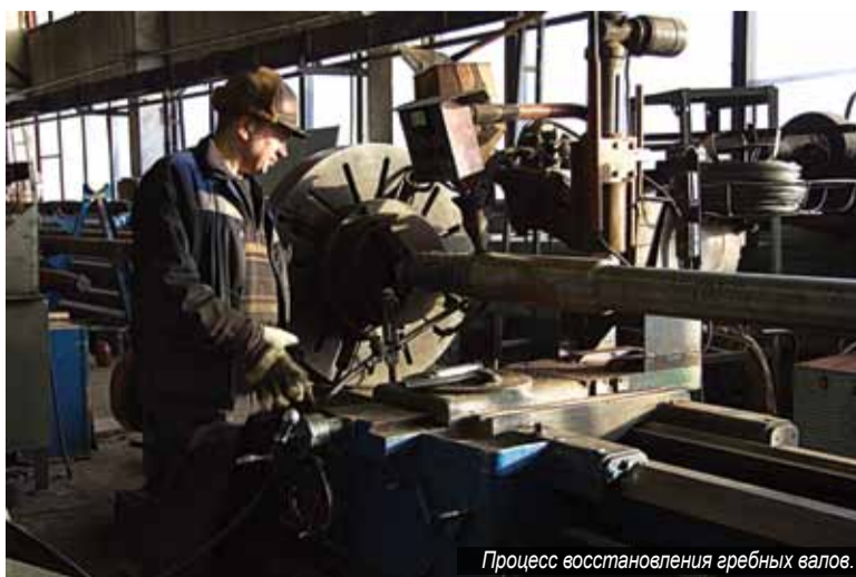
Шлифовка валового винта в механосборочном цехе.
