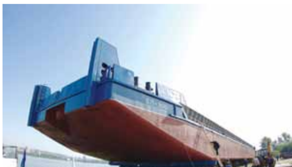
Новые суда для ЕРП строятся на Красноярской судовой верфи. Баржа грузоподъемностью 3000 тонн перед спуском на воду.
