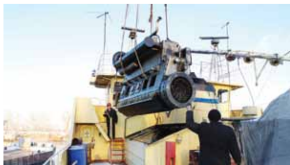
Пароходство располагает мощными судоремонтными базами. Замена двигателей на одном из теплоходов в КСЦ.
